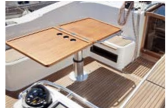
Der Cockpittisch ist ausklappbar und wahlweise elektrisch (Option) oder manuell höhenverstellbar (Serie)
