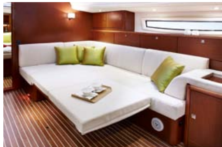
Salon mit Sitzcke und ausklappbarem Messtisch; optional ist der Tisch elektrisch absenkbar, sodass er in eine zusätzliche Liegefläche umfunktioniert werden kann
