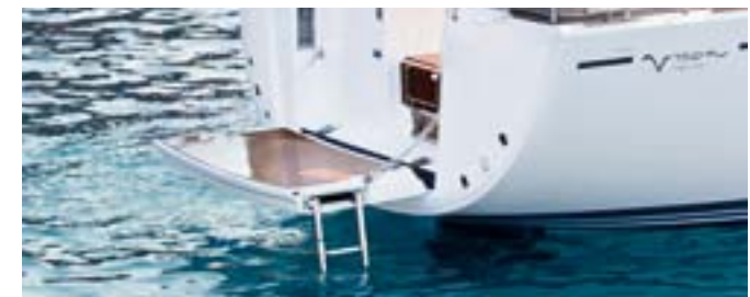
Manuell absenkbarer Badeplattform mit Duschvorrichtung und seitlich montierter Edelstahl-Badeleiter, die die Stirnseite der Plattform frei zugänglich lässt
