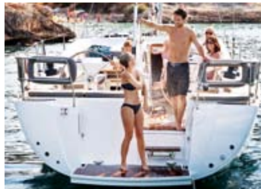
Manuell absenkbarer Badeplattform mit Duschvorrichtung und seitlich montierter Edelstahl-Badeleiter, die die Stirnseite der Plattform frei zugänglich lässt
